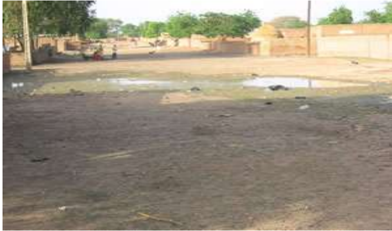
Photo 9 : Absence de réseau d'évacuation des eaux usées qui sont déversées dans la rue.
